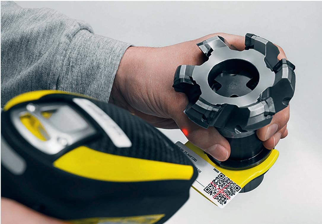
1 Bei zidCode scannt man den QR-Code des Werkzeugs direkt an der Maschine ein; dann werden die Daten an die Steuerung übertragen. zidCode 4.0 eröffnet neue Möglichkeiten © E. Zoller
