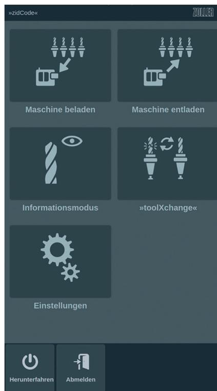
3 Einfach zu bedienende Software-Oberfläche mit unterschiedlichen Modulen und Funktionen: Werkzeuge beladen, Werkzeuge entladen, über ein Werkzeug informieren und Werkzeuge tauschen © E. Zoller
