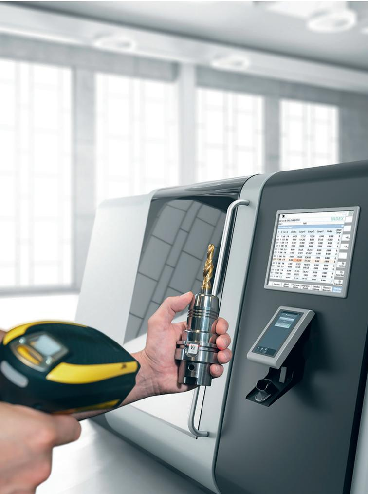
**2** Bei zidCode 4.0 wird jeder Werkzeughalter mit einem eindeutigen Code versehen, hier mit einem fertigungsresistenten Etikett idLabel. Der Code enthält eine ID, die in der z.One-Datenbank mit allen nötigen Werkzeugdaten gespeichert ist © E. Zoller
