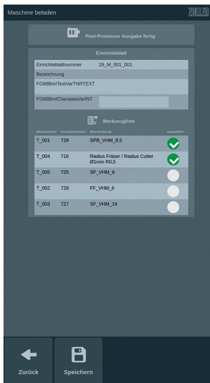
4 Die zidCode-4.0-Software von Zoller zeigt mit hohem Genauigkeitsgrad an, welche Präzisionswerkzeuge des digitalen Einrichteblattes schon gescannt und somit beladen sind © E. Zoller
